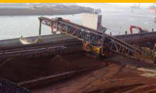
CINTA TRANSPORTADORA MÓVIL DE 65 METROS SOBRE ORUGAS PARA EL TRANS- BORDO DE MINERALES EN LA ACERÍA DE IJMUIDEN CON UNA CAPACIDAD DE 3000 TONELADAS POR HORA
