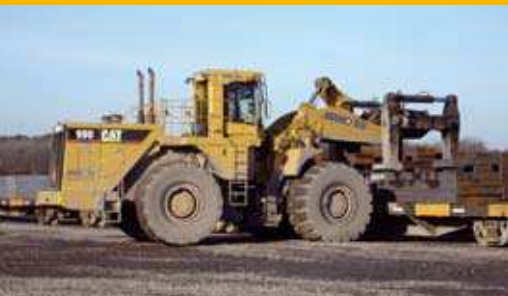
CATERPILLAR 990 PARA EL TRANSPORTE DE LÁMINAS EN LA ACERÍA EN IJMUIDEN
