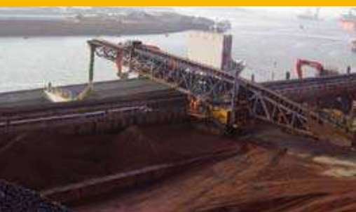
65 METER MOBILE TRANSPORTBAND OP RUPSEN TEN BEHOEVE VAN ERTS- OVERSLAG BIJ STAALFABRIEK IN IJMUIDEN, CAPACITEIT 3000 TON PER UUR
